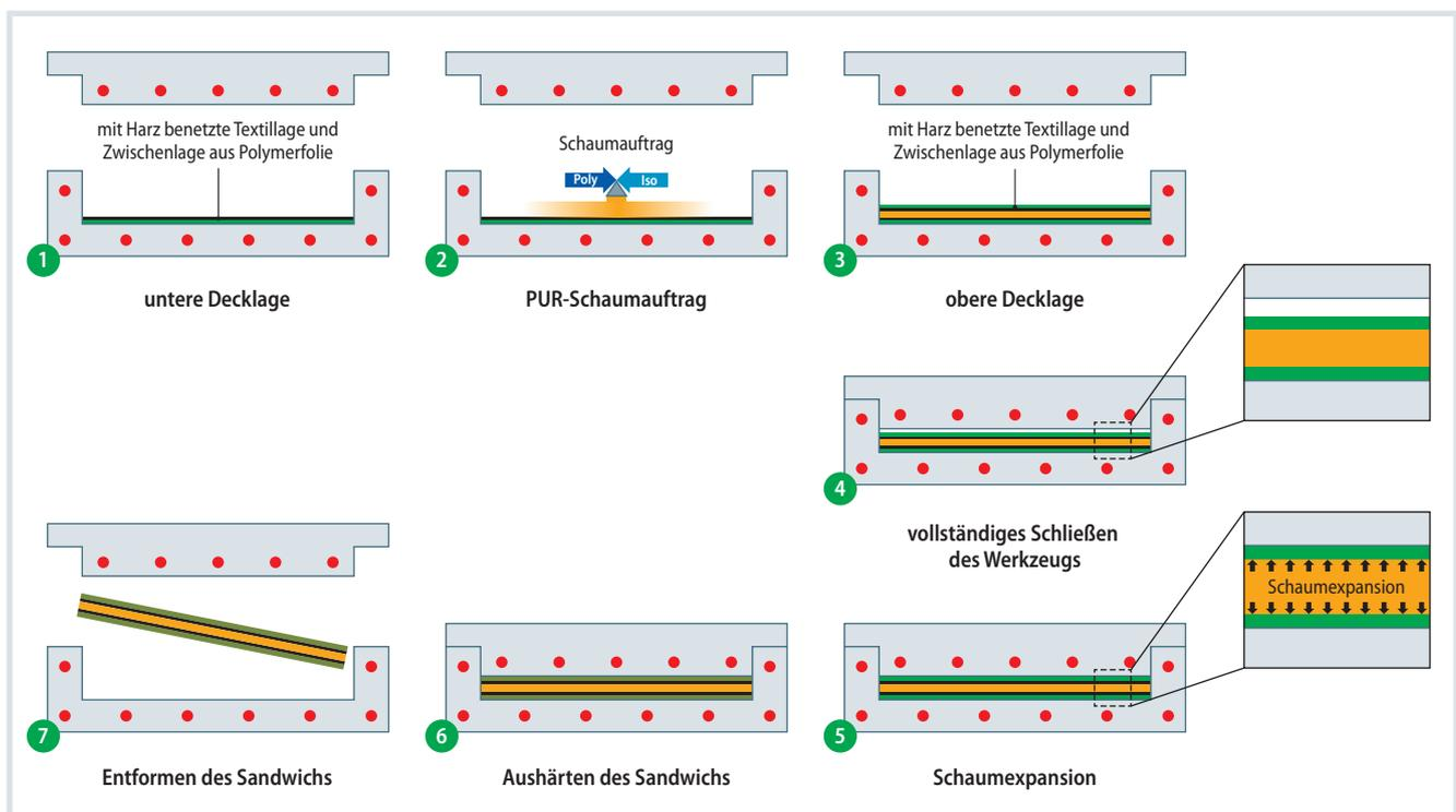
**Bild 2.** Schema für eine einfache und effiziente Fertigung von leichten, hochsteifen Sandwichstrukturen im D-SCM-Verfahren.
